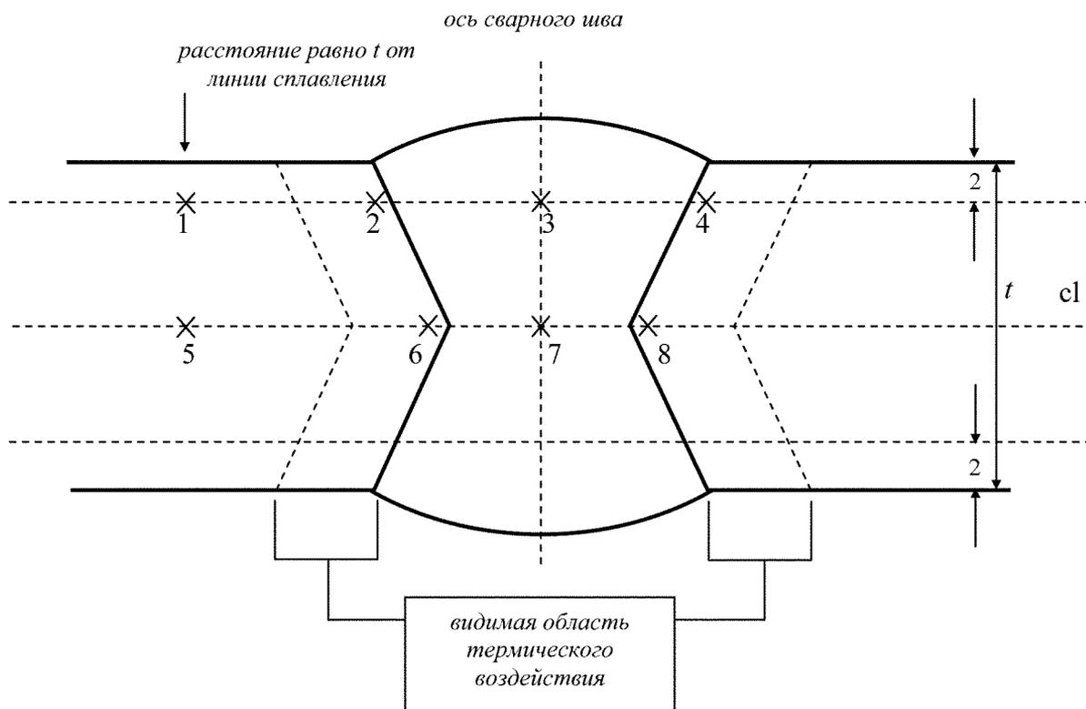
**Рисунок 2 - Испытание твердости продольного сварного шва.**
