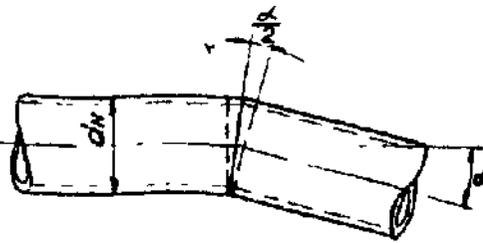
При делении длины окружности на 16 частей ордината косого среза трубы:
