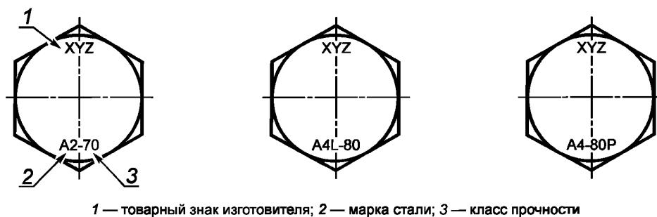
Рисунок 2 — Маркировка болтов и винтов с шестигранной головкой
