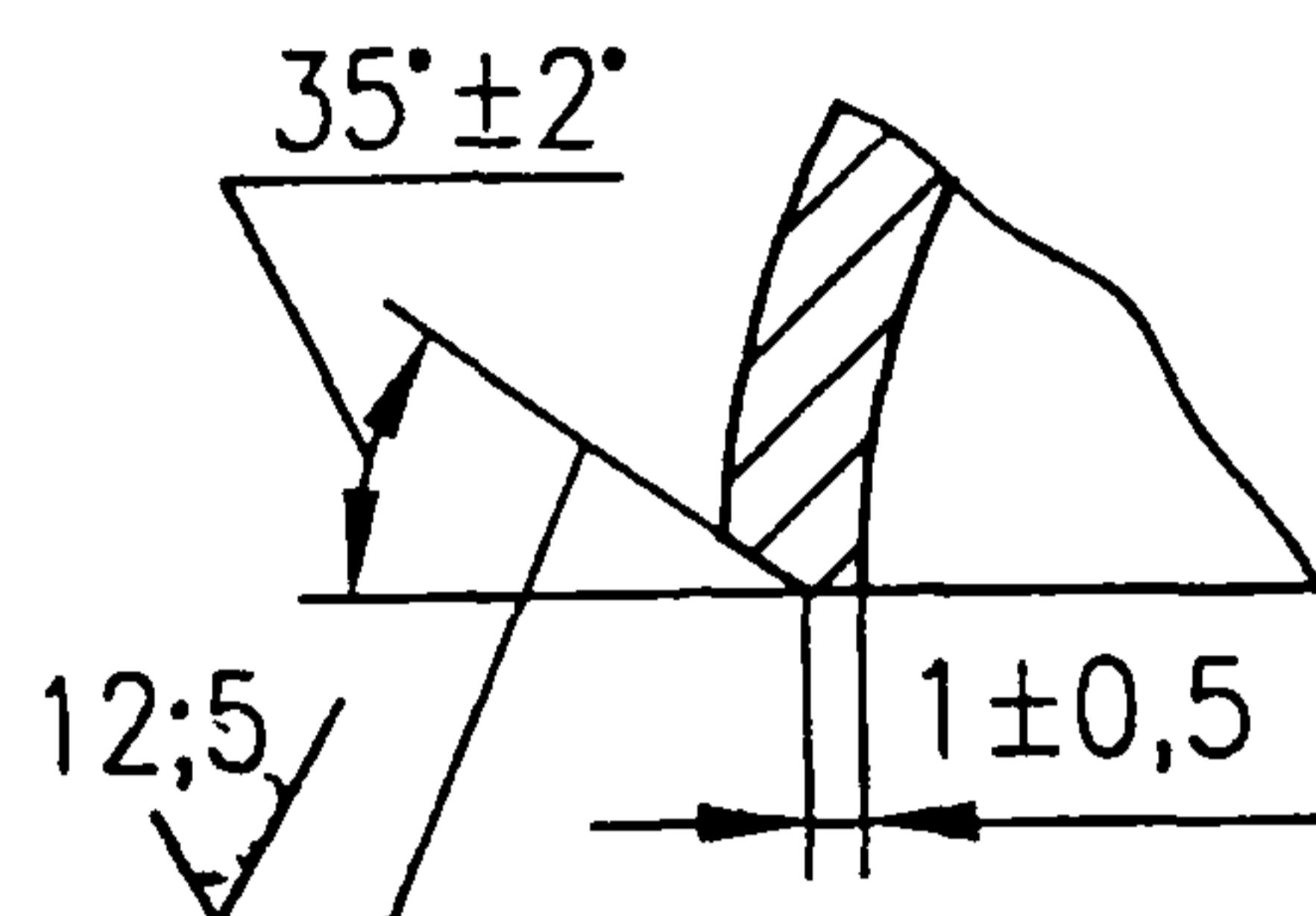
Примечание - Для отводов  $D_h = 57$  мм допускается торцовка без разделки кромок.
