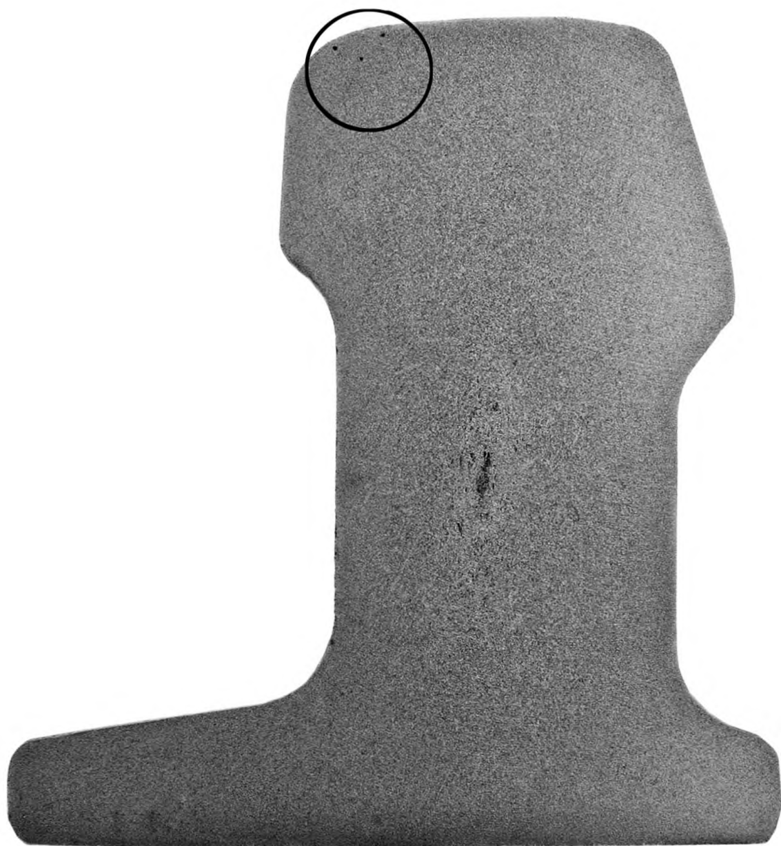
Рисунок Ж.4 — Точечная неоднородность в головке рельса
