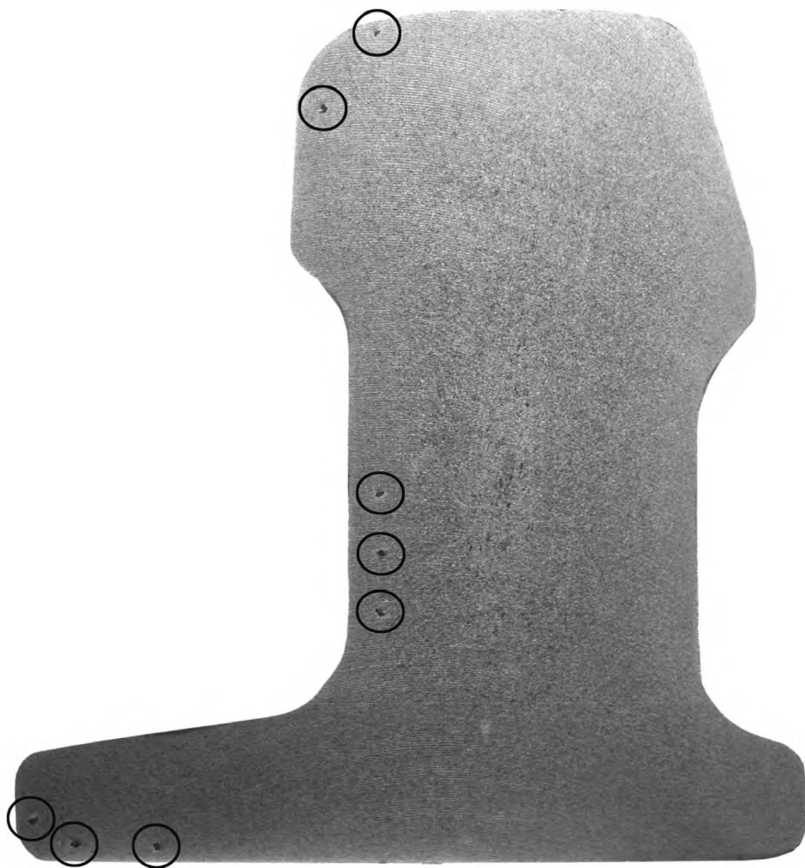
Рисунок Ж.6 — Точечная неоднородность в головке, шейке и подошве рельса
