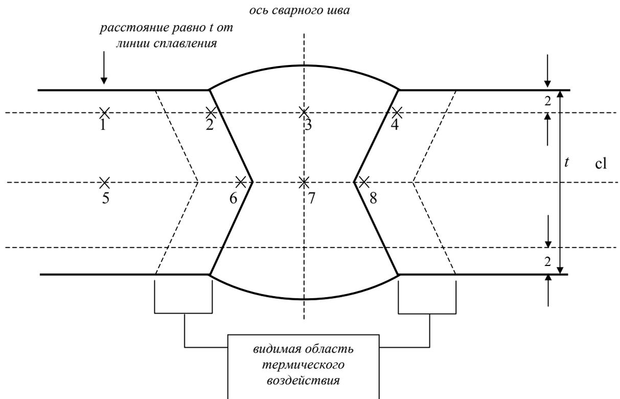
**Рисунок 2 - Исследование твердости продольного сварного шва.**
